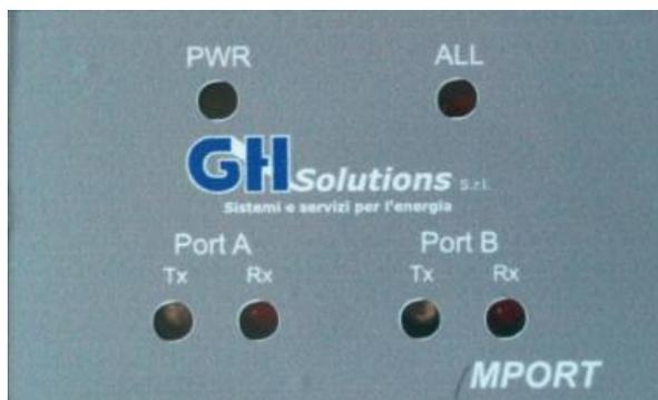
La figura sopra riportata indica il pannello frontale dell'MPORT che è costituito principalmente da un'interfaccia luminosa composta da 6 (sei) led luminosi che indicano:
