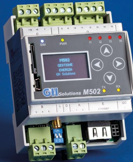
**L'M502 è un dispositivo progettato e realizzato per misurare e gestire flussi energetici mediante dati prelevati dal campo.**
